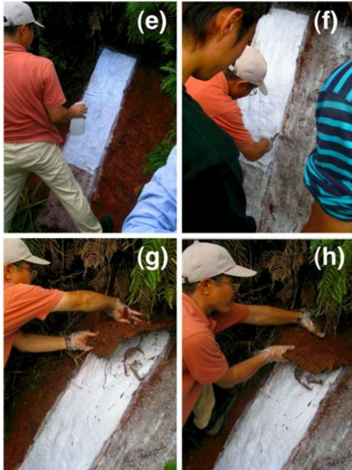
図 8.3 モノリス製作の詳細（その2）：(e) ガーゼまたは寒冷紗をその上から貼り付け、その上から接着剤を塗布して、さらに水を吹き付ける（あまり幅を広げることがないように気をつける）、(f) 昼食を食べながら接着剤と水が反応して固化するのを待ち、約1時間後に貼り付けたガーゼに沿って切り目を入れる、(g) ガーゼの両端に切込みを入れた後、土壌断面の上方から剪定ばさみで土壌表層に密集している根を切りながら、下方に徐々に剥いでゆく、(h) 切り取りを入れた後、手で徐々に剥いでゆく（土壌を剥ぎ取るので、かなり力が必要となる）
