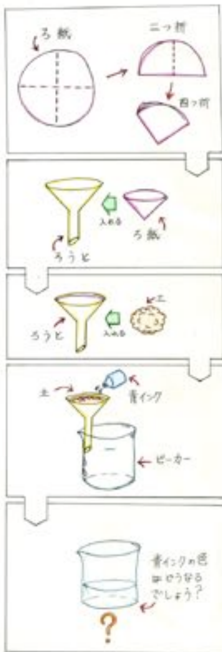
図 7.6 土壌の吸着性を調べる実験の手順
