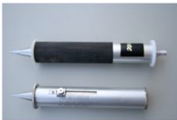
図 6.9 土壌硬度計 (上:プッシュコーン式, 下:山中式)
