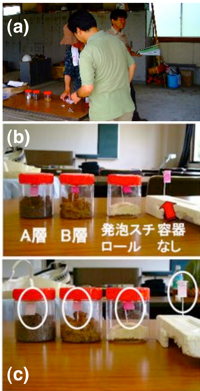
図 7.5 土壌呼吸を調べる実験の様子：(a) 屋外で実験開始（人間の呼気による炭酸ガスの影響を少なくするため実験は野外で行います），(b)8 分経過（実験開始後容器を室内へもって入り，容器に入れないろ紙片も対照区として観察します），(c)16 分経過（「A 層」と「容器なし」のろ紙片が白色に変化してるけれども発泡スチロールのろ紙片はほとんど変色していない様子が観察されます）
