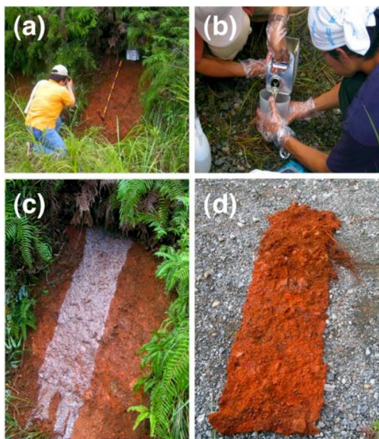
図 8.1 モノリス製作の概要：(a) 代表的な土壌断面の選択，(b) 接着剤の注入，(c) 接着剤の塗布，(d) 剥ぎ取り終了後の土壌の様子（これを板に貼り付けて，スケールをつけ，完成させる）
