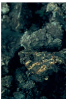
硫酸土壌中のパイライトの電子顕微鏡写真。湛水状態においてバクテリアによる還元の結果、結晶の成長は重金属とヒ素を環境から除去する。
