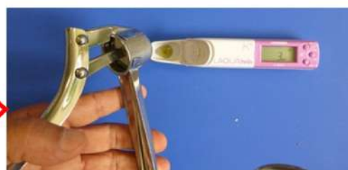
⑦ 直接Kイオンメーターに搾汁液を入れて測定する
