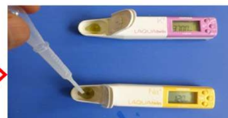
⑧ 搾汁液をNaイオンメーターに移して測定する
